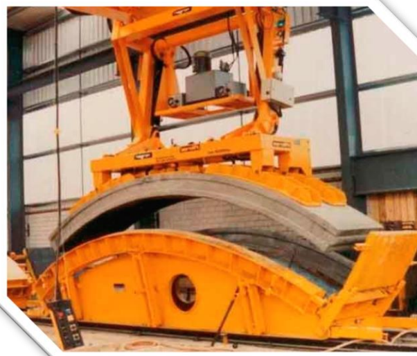
Uso de MOLDUCONSA® GOLD para desmoldar dovelas.
